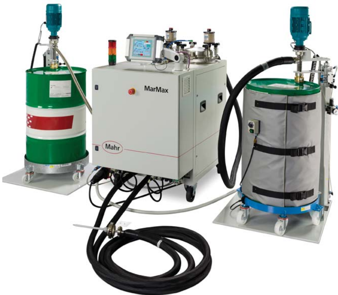
Příklad použití ohříváče sudu WODH s čerpacím zařízením.
