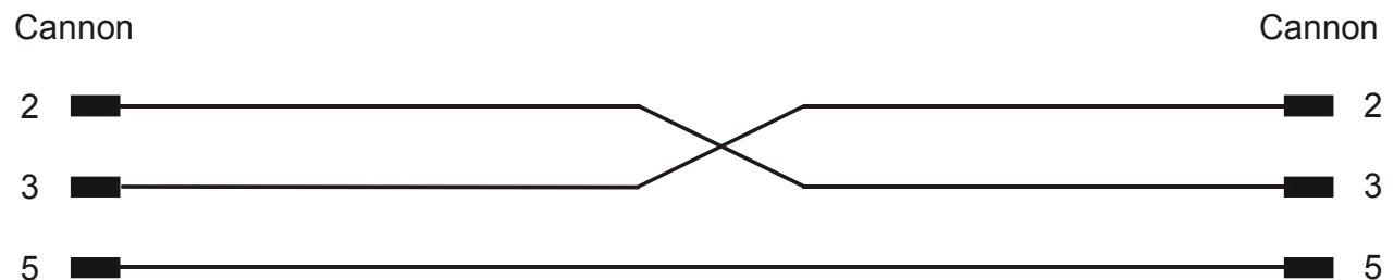
Zapojení konektoru Cannon 9 pin:
