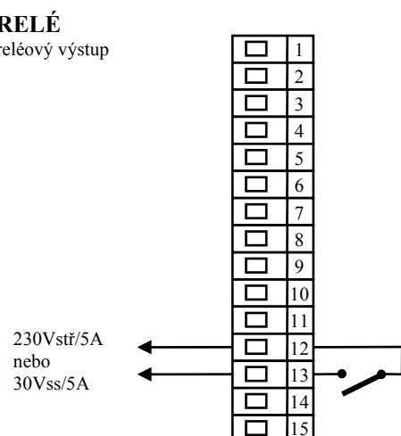
Výstup RELÉ *je galvanicky oddelený od země přístroje*. U tohoto výstupu je nutné vnější vodiče fixovat tak, aby v případě uvolnění vodiče ze svorky nedošlo ke snížení izolace mezi kategoriemi síťového napětí a bezpečného napětí.
