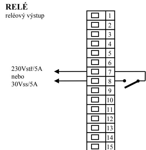
Výstup RELÉ je galvanicky oddělený od země přístroje. U tohoto výstupu je nutné vnější vodiče fixovat tak, aby v případě uvolnění vodiče ze svorky nedošlo ke snížení izolace mezi kategoriemi síťového napětí a bezpečného napětí.
