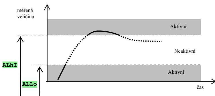
Alarmové meze jsou nastavovány v absolutních hodnotách.
